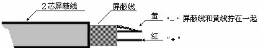
红色芯线接 XPS 的+端，屏蔽线和黄色芯线拧在一起接一端，探头接线板+端和一端与之对应连接；
