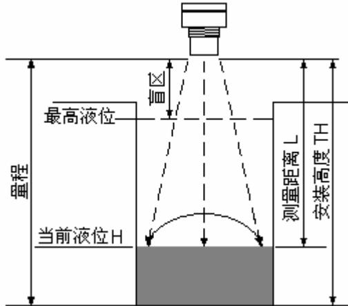
如上图所示, 仪表的探头发波打到液位后反射回探头, 探头接收到后计算发波到收波的时间, 得到测量距离  $L$ , 仪表安装高度  $TH$  减去测量距离  $L$  将得到当前液位  $H$ 。
