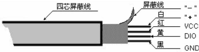
色) 芯线接 XPS 的 + 端, 屏蔽线接一端, 红色芯线接 XPS 的 VCC, 黄色芯线接 XPS 的 DIO, 黑色芯线接 XPS 的 GND, 探头接线板部分对应连接;
